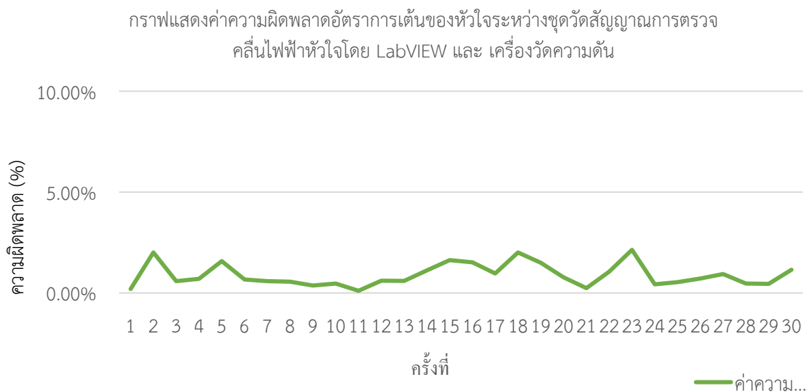
รูปที่ 4.53 กราฟแสดงค่าความผิดพลาดอัตราการเต้นของหัวใจระหว่างชุดวัดสัญญาณการตรวจคลื่นไฟฟ้าหัวใจโดย LabVIEW และ เครื่องวัดความดัน คนที่ 5
