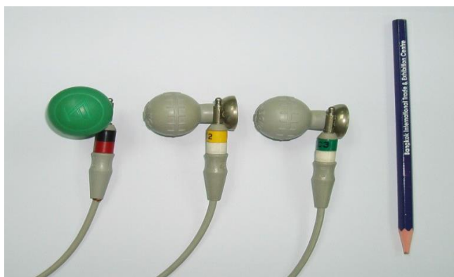
รูปที่ 2.6 อิเล็กโทรดชนิดถ้วยสุญญากาศ (ชนิดใช้ได้หลายครั้ง)
