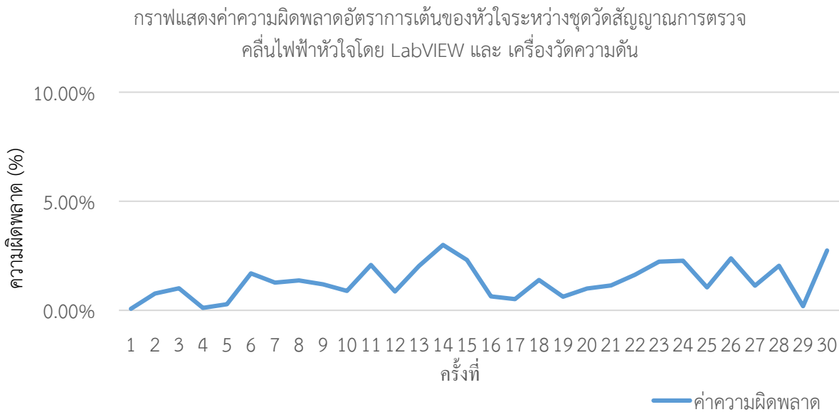
รูปที่ 4.51 กราฟแสดงค่าความผิดพลาดอัตราการเต้นของหัวใจระหว่างชุดวัดสัญญาณการตรวจคลื่นไฟฟ้าหัวใจ โดยLabVIEW และ เครื่องวัดความดัน คนที่ 4
